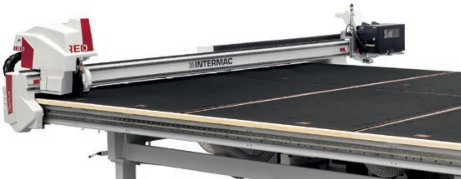
Le bâti de la machine est composé d'une structure rigide et rectifiée sur laquelle sont appliqués des panneaux en bois rectifiés qui assurent la plus grande planéité de la zone de façonnage ; une condition nécessaire pour la réussite optimale de l'incision et du rompage du verre.
